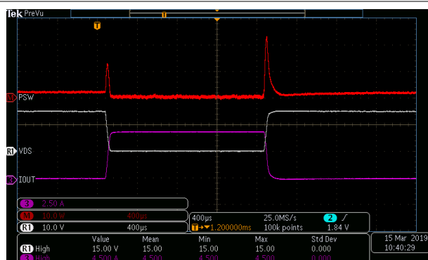
图 2-7. 实测开关损耗波形
