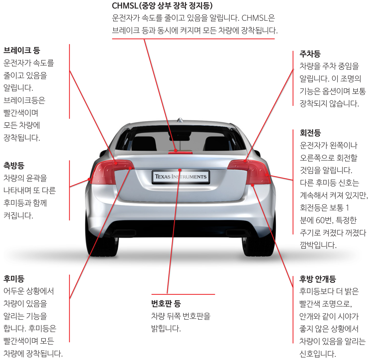
그림 1. 후미등 시스템의 구성 요소
