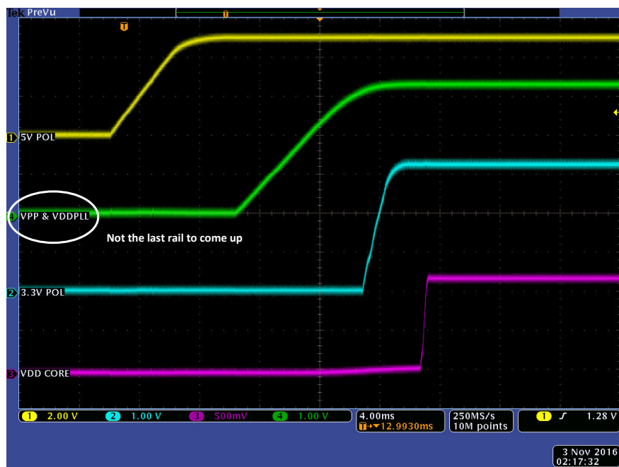
图 3-6. RTG4 经过修改的开发板，满足第一项上电要求
