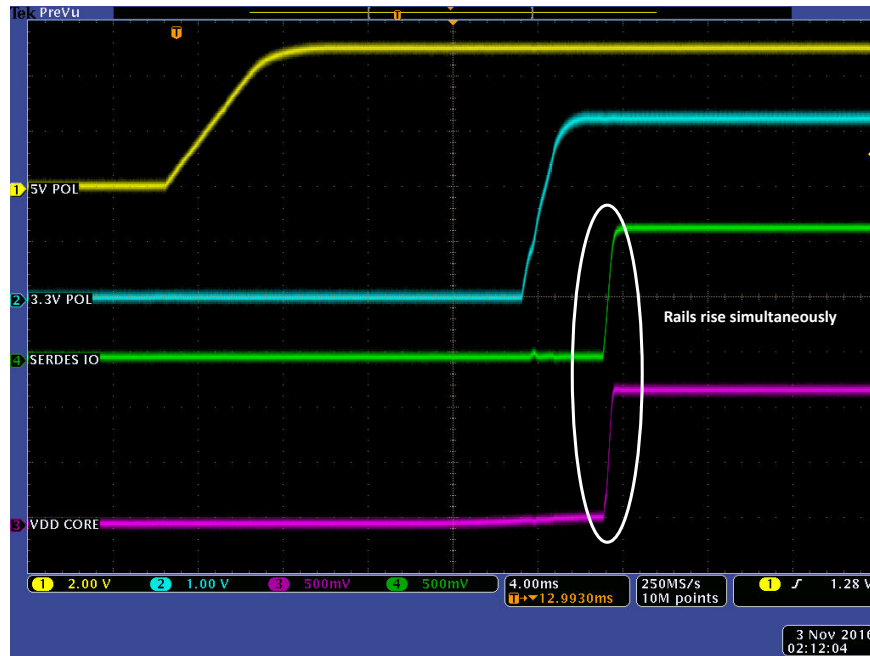
图 3-7. RTG4 经过修改的开发板，满足第二项上电要求
