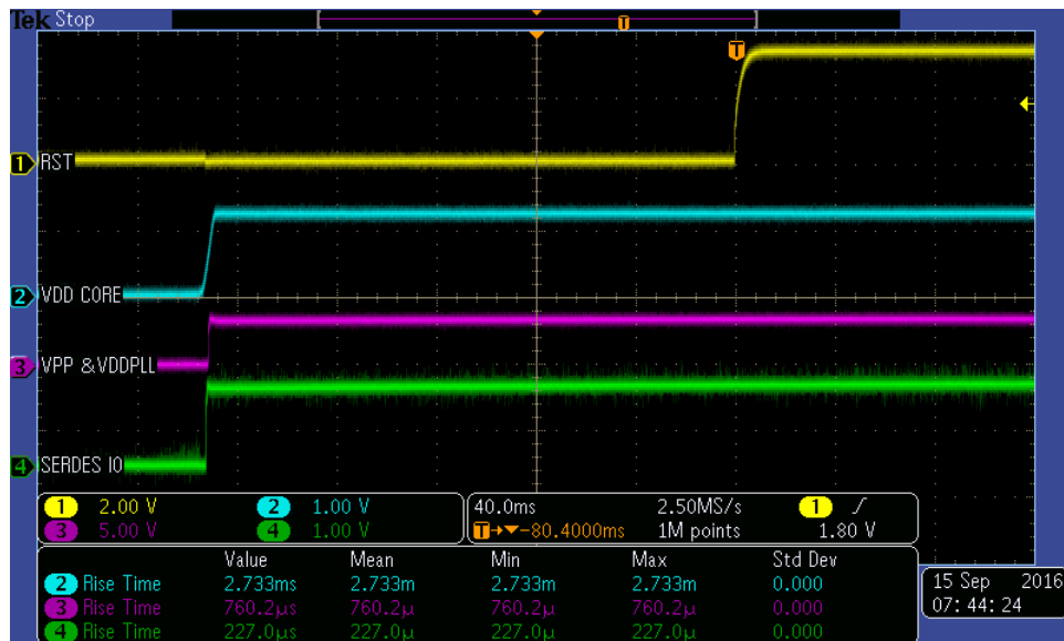
图 2-2. RTG4 开发板启动序列
